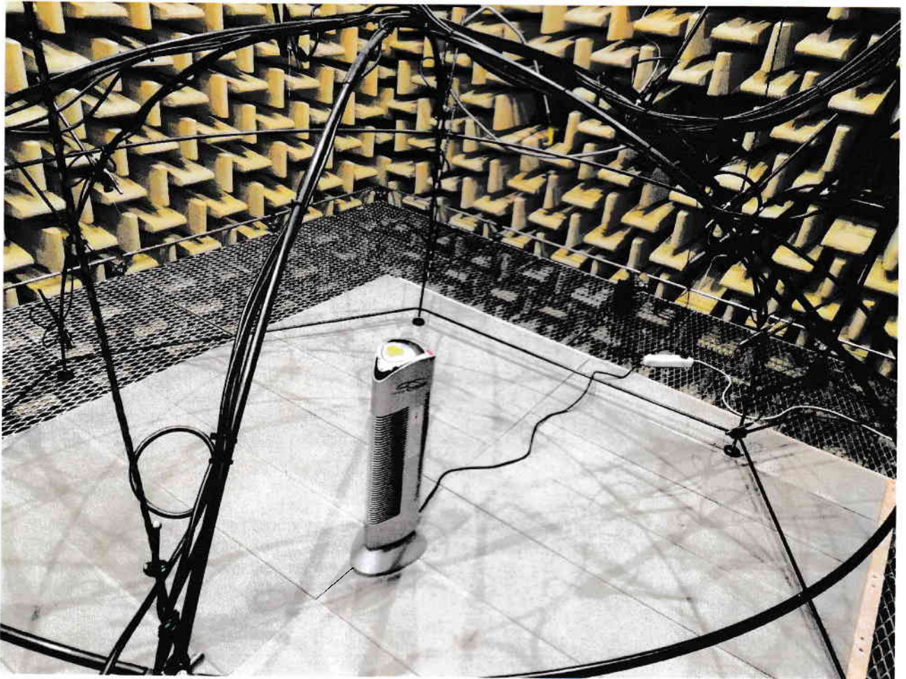
Obr. 6: Sestava měření (vzorek umístěný pod hemisférou s 20 mikrofony)
